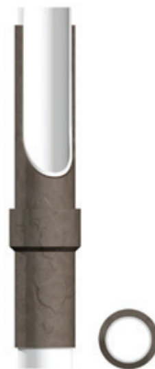
Figur 6 Relining av avloppsstammar
